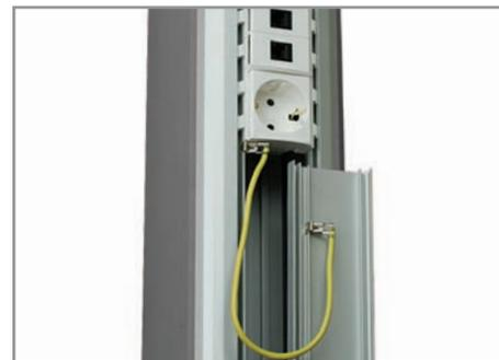
Клемму провода заземления (E0001C) защелкните на профиль замка колонны вплотную к каркасам ЭУИ. Вторую клемму провода E0001C установите на направляющую крышки
