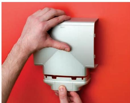
При отводе от трассы коробов 140x50 мм короба 90x50 мм вставьте в декоративную накладку тройника переходник 140-90x50, код 01408G. При отводе короба 110x50 вставьте переходник 140-110x50, код 01010G
