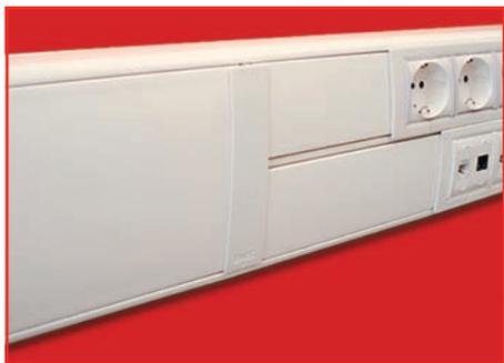
Короб 140x50 мм с одной широкой крышкой можно использовать как магистральный. С двумя узкими крышками короб 140x50 мм можно использовать как электроустановочный. Разделитель имеет перфорацию для перевода кабеля из одной секции в другую. Во все короба можно установить ЭУИ серии "Brava", "Viva" и 45x45 мм
