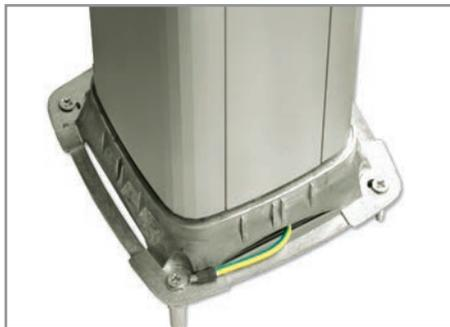
Для заземления колонны подведите провод сечением 2,5 мм<sup>2</sup> с изоляцией желто-зеленого цвета. Во время монтажа базы установите на провод заземления РЕ кабельный наконечник с отверстием под винт. Закрепите провод в отверстии базы
