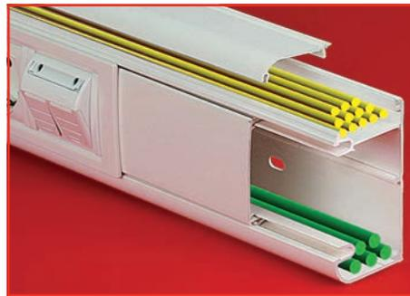
Уникальная конструкция – в коробе 90/2х50 мм (код 09500) имеется встроенный разделитель, создающий 2 независимых отсека с крышками для удобной прокладки различной проводки. Разделитель имеет перфорацию для перевода кабеля из одной секции короба в другую при необходимости
