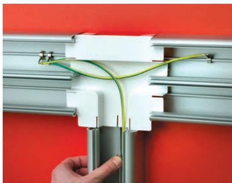
Проводом заземления соедините основание одного из двух коробов с основанием третьего короба. Клеммы защелкиванием установите на направляющие на дне этих коробов
