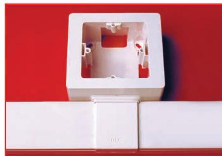
3. Установите крышку адаптера, зафиксировав ее в базе адаптера, а затем – на нижней кромке миниканала. Сдвиньте крышки миниканала под адаптер и установите коробку
