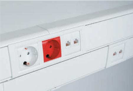
Короб 140х50 мм с одной широкой крышкой можно использовать как магистральный. Короб 140х50 мм с двумя узкими крышками можно использовать как электроустановочный. Разделитель имеет преперфорацию для перехода кабеля из одной секции в другую. Во все короба можно установить ЭУИ серии "Avanti", "Viva" УЭИ размером 45х45 мм
