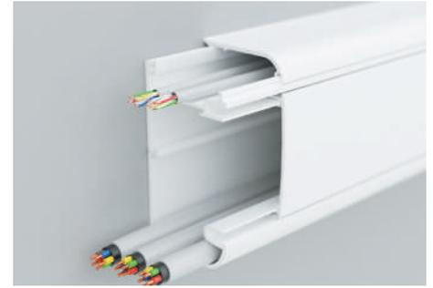
Уникальная конструкция: в коробе 90/2х50 мм (код 09500) встроен разделитель, создающий 2 независимых отсека с крышками для удобной прокладки различной проводки. Разделитель имеет преперфорацию, при необходимости кабель можно перенести из одной секции короба в другую
