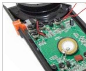
На печатной плате токоизмерительных клещей имеется 7 регулировочных резисторов, которые позволяют наиболее точно настроить прибор и максимально снизить погрешность измерений.
