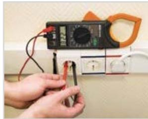
Измерение переменного тока и напряжения.
