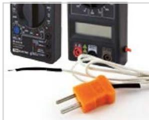
Мультиметры М-838, DT9208А и клещи М266С позволяют проводить измерение температуры окружающей среды или поверхности материалов.
