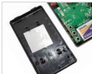
С 2017 года усовершенствована технология производства мультиметров: внутри на задней крышке корпуса добавился заземляющий экран, который снижает внешние помехи и увеличивает точность и стабильность измерений.
