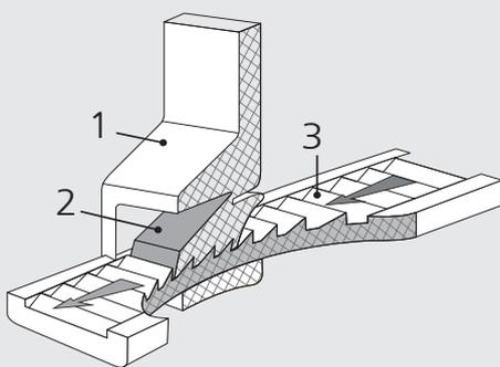
Устройство замка стандартной кабельной стяжки представляет собой нейлоновую головку (1) с фиксатором (2). На внутренней рабочей поверхности фиксатора расположены пилообразные выступы.
