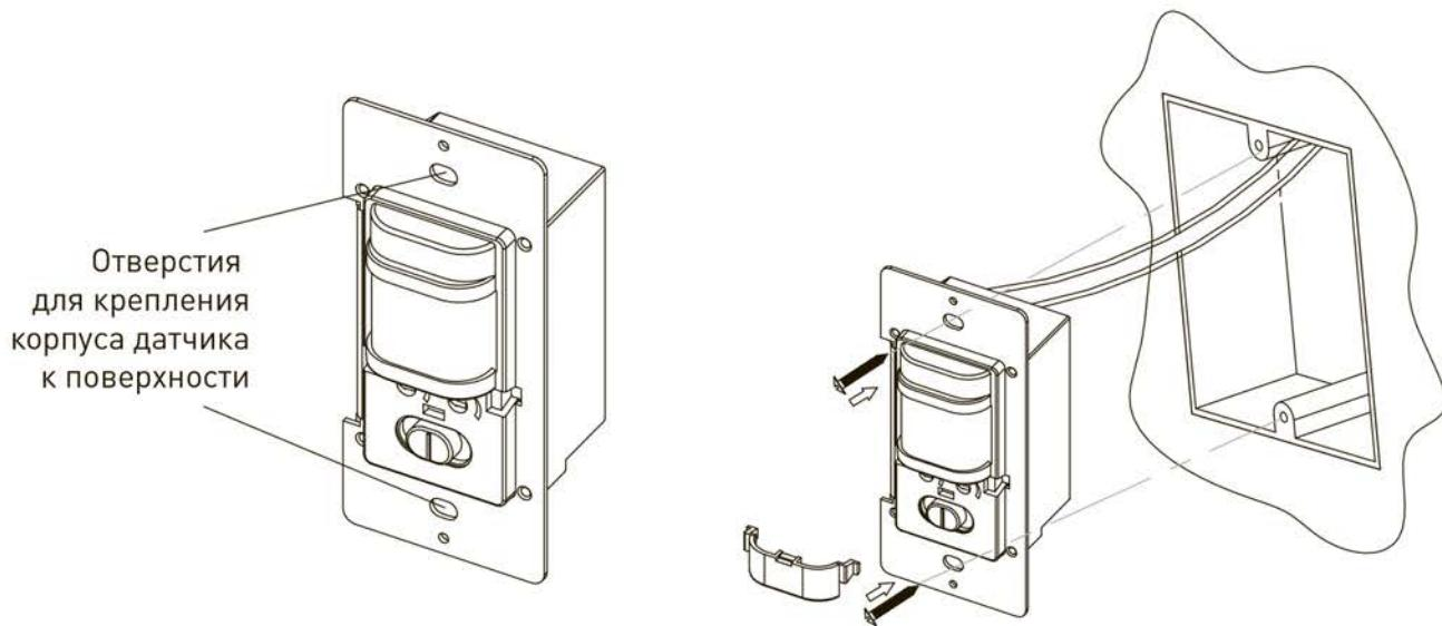
**Рис.6. Монтаж датчика.**
