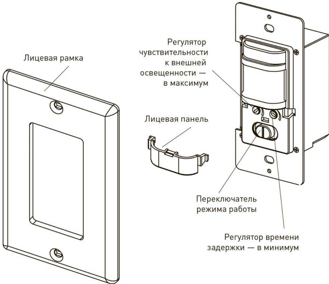
**Рис.3. Начальные установки регуляторов во время настройки датчика.**
