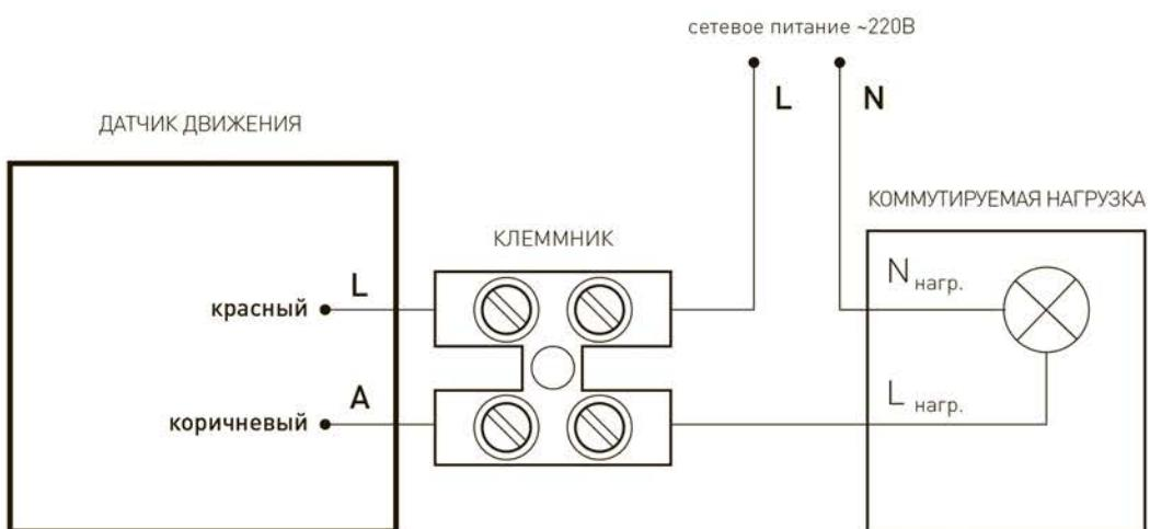
Рис.5. Подключение датчика движения.
