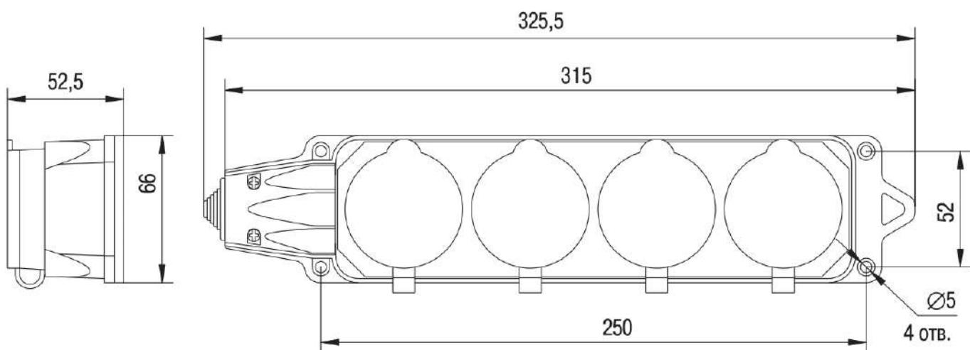
Рисунок 12 – Розетка (колодка) четырехместная с защитными крышками РБ34-1-0м
