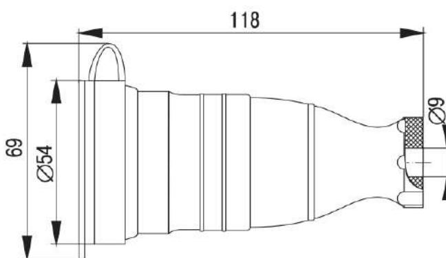
Рисунок 8 – Розетка с защитной крышкой переносная РБп13-1-0м
