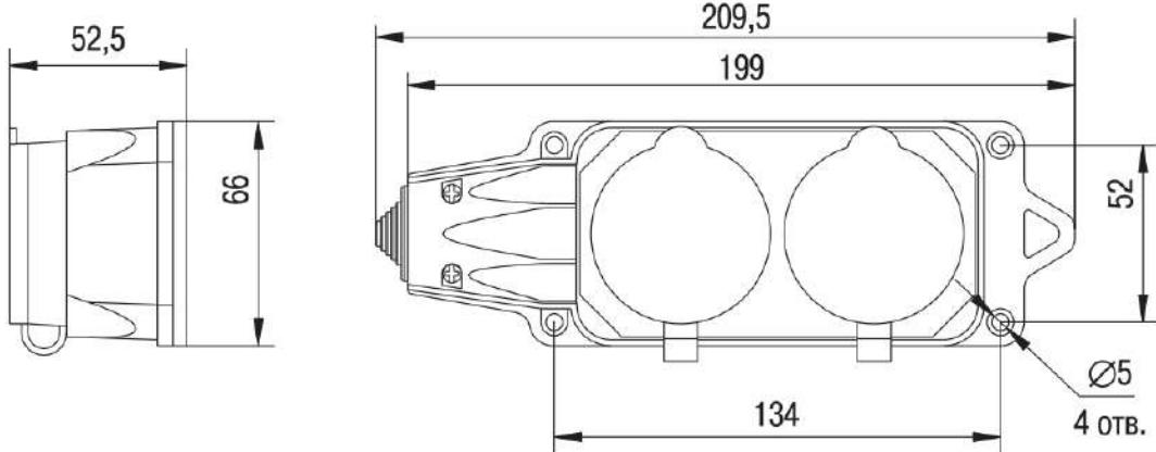
Рисунок 10 – Розетка (колодка) двухместная с защитными крышками РБ32-1-0м
