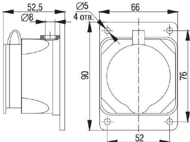
Рисунок 9 – Розетка с защитной крышкой настенная РБ13-1-0м
