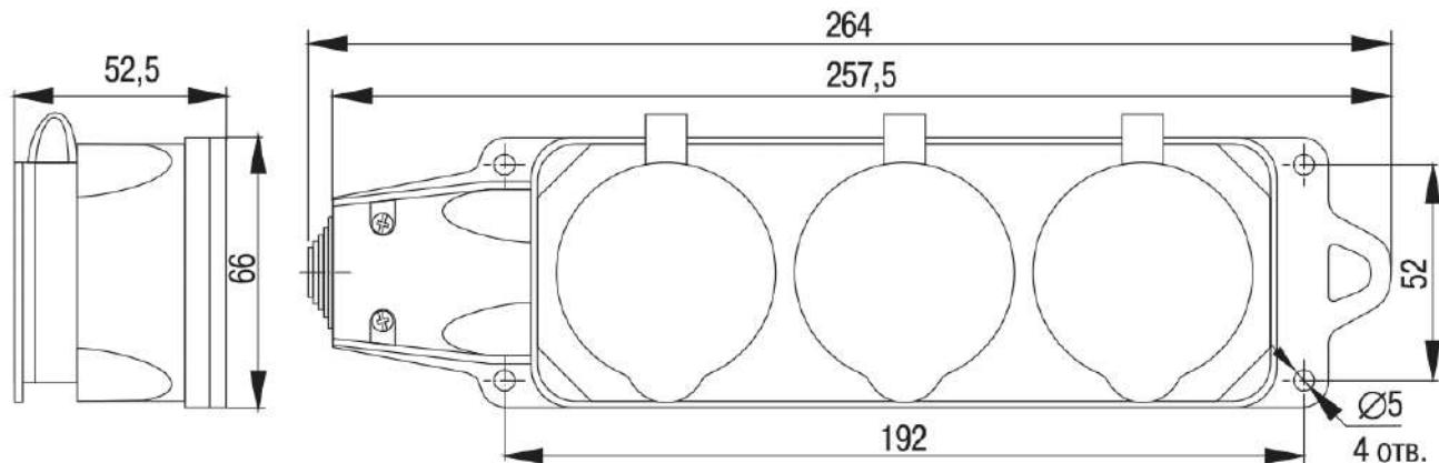
Рисунок 11 – Розетка (колодка) трёхместная с защитными крышками РБ33-1-0м
