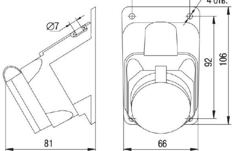
Рисунок 13 – Розетка с защитной крышкой угловая настенная РБу13-1-0м
