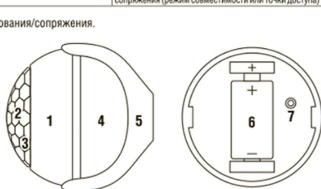
1 – верхняя часть корпуса; 2 – термочувствительная зона; 3 – светодиодный индикатор; 4 – задняя крышка датчика; 5 – держатель датчика; 6 – элемент питания; 7 – кнопка сброса/управления.
