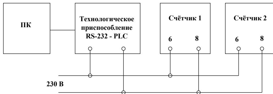
*Примечание – Счётчики и технологическое приспособление должны быть на одной силовой линии.*
