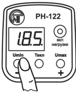
Нажмите кнопку **Umin/-** – на дисплее отобразится заводская установка параметра с мигающими точками (18.5.)
