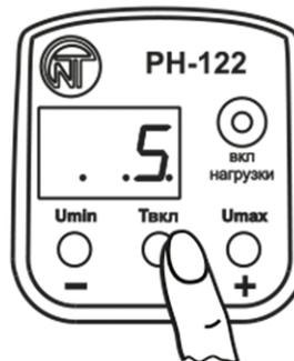
Нажмите кнопку **Tвкл** – на дисплее отобразится заводская установка параметра с мигающими точками (.5.)
