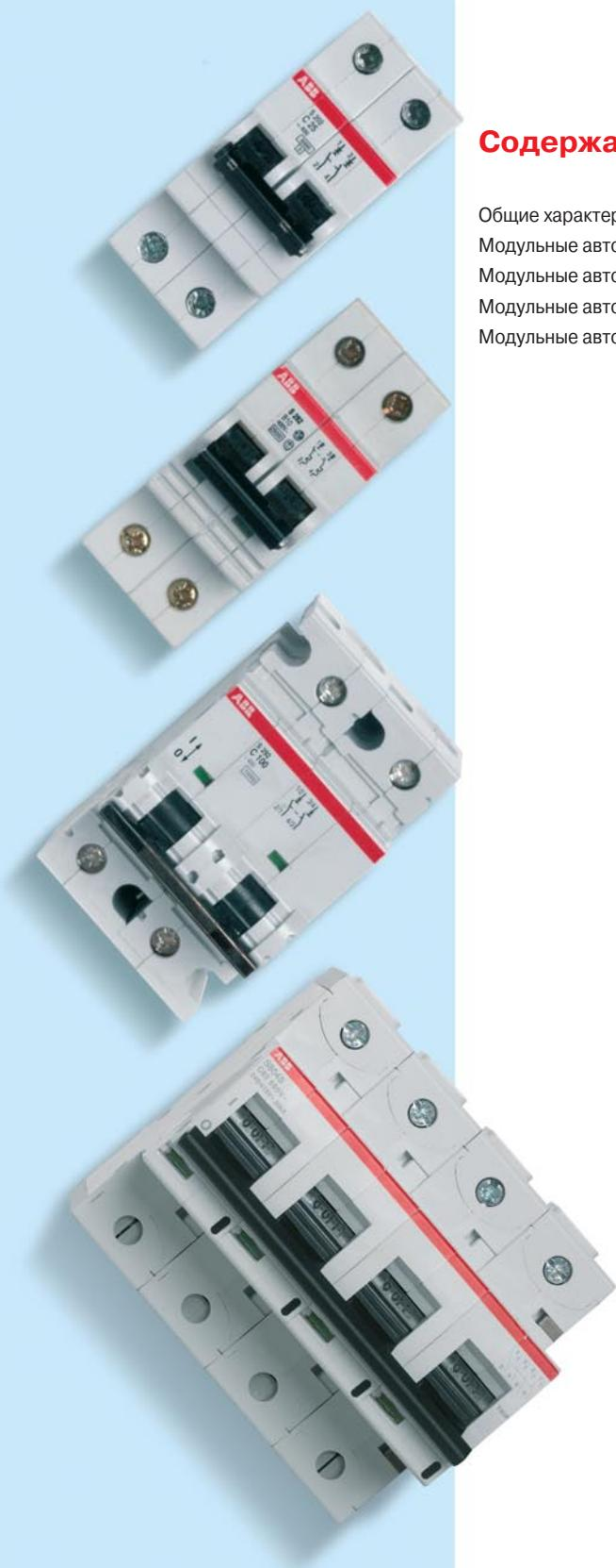
**ПРИМЕЧАНИЕ.** На корпусе автоматических выключателей серии S200 указано два значения отключающей способности: спереди -  $I_{\text{on}}$  согласно IEC/EN 60898 сбоку -  $I_{\text{cu}}/I_{\text{cs}}$  согласно IEC/EN 60947-2 в зависимости от номинального тока. Значения отключающей способности для характеристик срабатывания KZ, указанное спереди на корпусе автоматического выключателя S200, соответствует стандарту VDE 0660.
