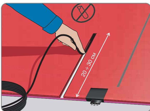
Для установки датчика нужно в верхнем слое нагревательного мата вырезать полоску шириной примерно 5 мм. В полученном вырезе-канавке
