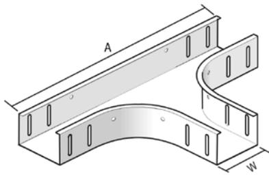
Фиксируется на кабельном лотке
