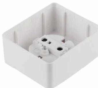
Изделия IP54 также монтируются при помощи саморезов. При этом подвод кабеля осуществляется через герметичную вставку. На тыльной стороне изделий нанесена схема разметки для случаев монтажа изделий на кирпичную или бетонную стену. Корпуса оснащены заземляющей клеммой.
