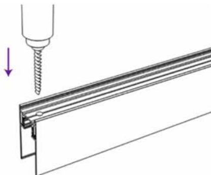
Для ввода кабеля питания необходимо просверлить отверстие в шинопровode, после этого необходимо снять фаски и удалить заусенцы.
