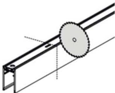
Использование для резки шинопровода ножовки и подобных устройств не допускается т.к. может вызвать повреждение шинопровода и невозможность его дальнейшего использования.
